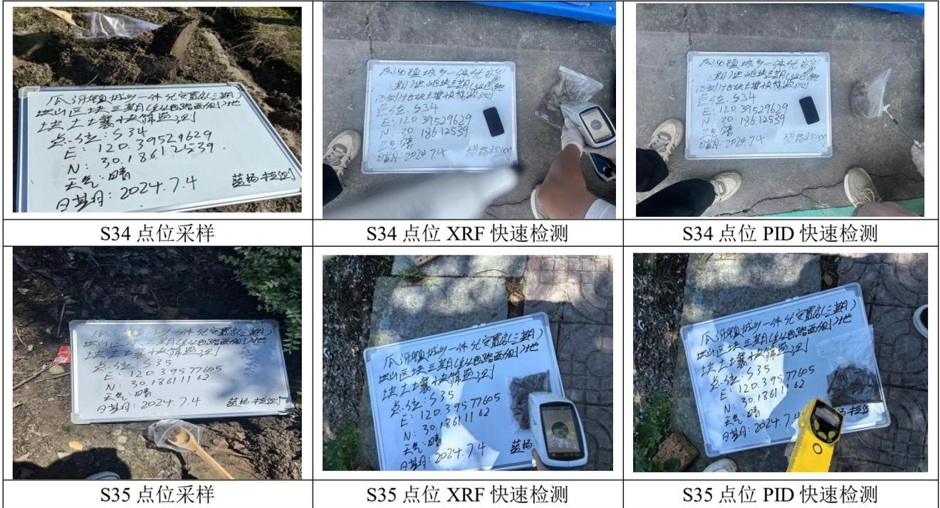
图 5.8-3 现场快速检测照片
