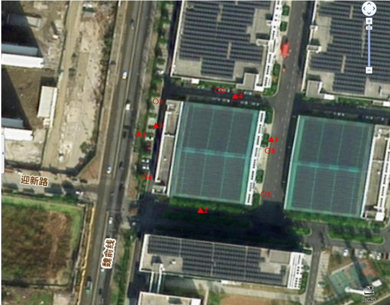
注：★表示废水监测点位，○表示无组织废气和环境空气监测点位；▲表示厂界噪声监测点位；
