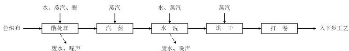
图 3-15 退浆工艺流程图
